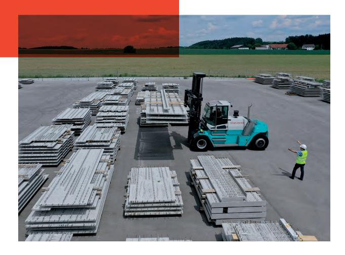
"Auf dem Gelände unseres Beton- und Ziegelwerks geht es staubig zu. Damit unsere bis zu 14 Tonnen schweren Betonteile sicher vom Werk ins Lager und auf den Lkw kommen, müssen deshalb alle Maschinen auch bei rauen Bedingungen präzise arbeiten. Der Schwerlaststapler von Konecranes ist mit seiner speziell angepassten Gabelerweiterung und Hochleistungs-Filtersystem optimal für den Einsatz bei uns."
